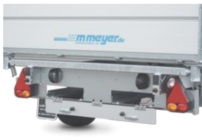
2 Auffahrschienen (mit Klappe) 2 boîtiers pour rampes (avec clapet rabattable) 2 storage shafts for skids (with flaps)
