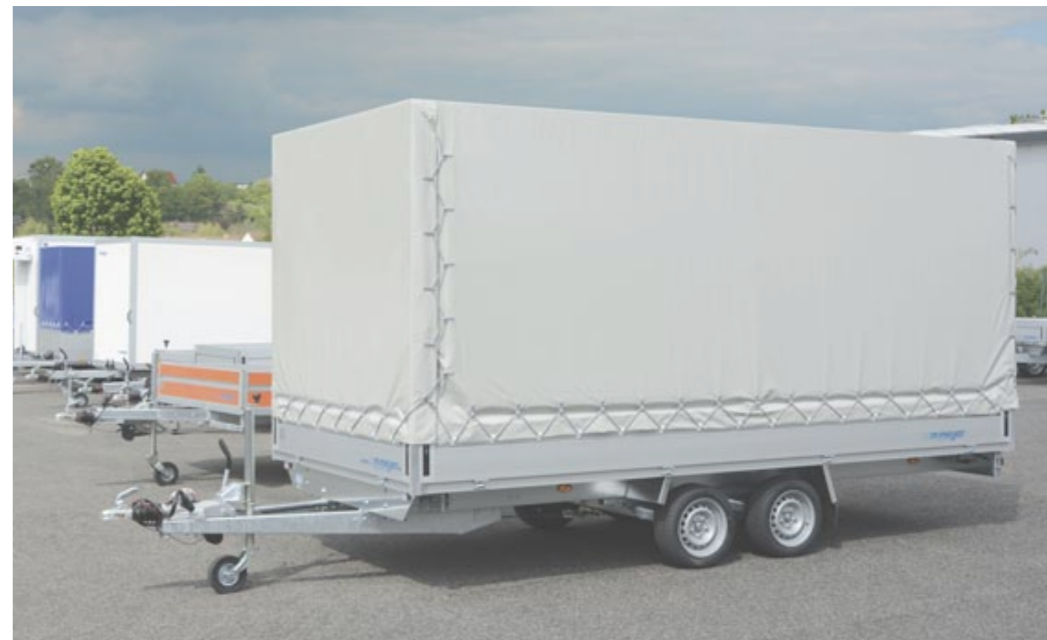
HLC 3546/210 Stützrad verstärkt, klappbar, mittig; Zubehör: Plane (Farbe: grau) und Aluminiumspiegel HLC 3546/210 Roue jockey renforcée, automatique, au milieu du timon ; options : bâche (couleur: gris) et ossature en alu HLC 3546/210 Reinforced jockey wheel, automatic, in the middle of the drawbar; optional extras: canvas top (colour: grey), aluminium support
