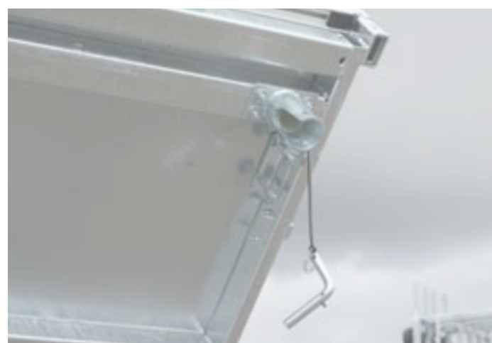
Kipplager mit Steckbolzen Palier à bascule avec goupilles de sécurité Rocker bearing with safety pin
