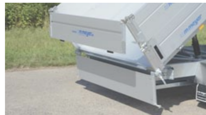
Zubehör: Alubordwandaufhöhung abnehmbar; untere Heckwand links: aufgeklappt; untere Heckwand rechts: aufgeschwenkt (bei HKC und HKCR) Option: ridelles supplémentaires en aluminium amovibles; illustration des 2 manières d'ouvrir la ridelle arrière basse (HKC et HKCR) Optional extra: additional aluminium side panels which can be taken off; illustration of the 2 ways of opening the lower rear panel (HKC and HKCR)
