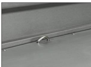
6 starke Zurrösen im Stahlboden eingelassen
