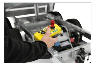
Elektrisch-hydraulische Kippvorrichtung bei Tandem-Modellen
