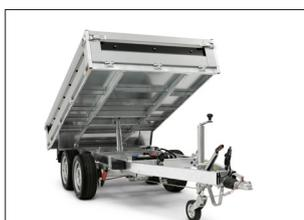
Geschweißtes, feuerverzinktes Vollrahmen-Chassis aus Stahl
