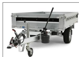
Doppelwirkende hydraulische Kippvorrichtung bei Einachs-Modellen
